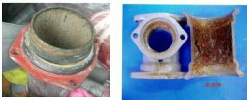
④MD継手の腐食 (配管・通気管)
